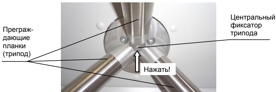
Рис.3 Место расположения центрального фиксатора трипода
